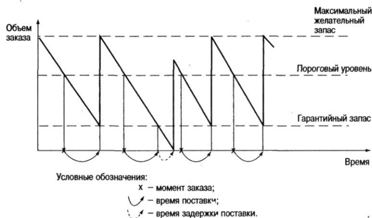
Рис. 8. Система с фиксированным размером заказа
