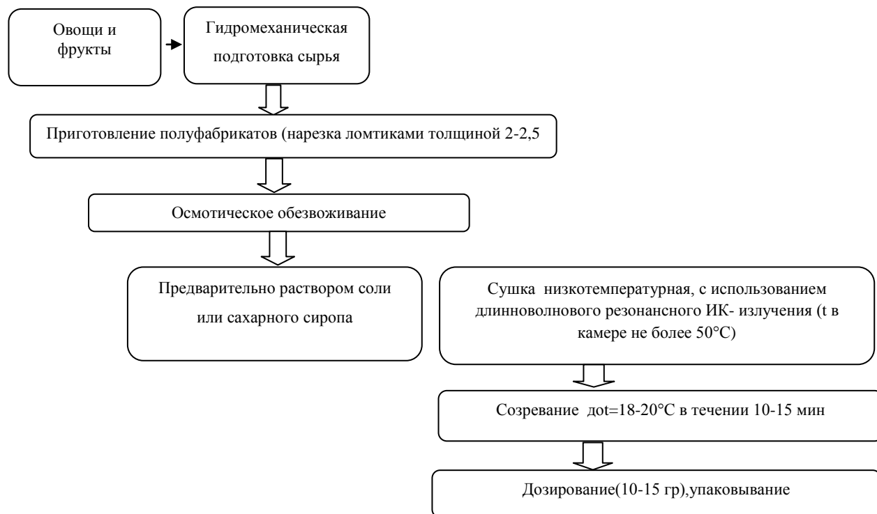
Рис. 2. Схема технологического процесса комплексной безотходной переработки тыквы
