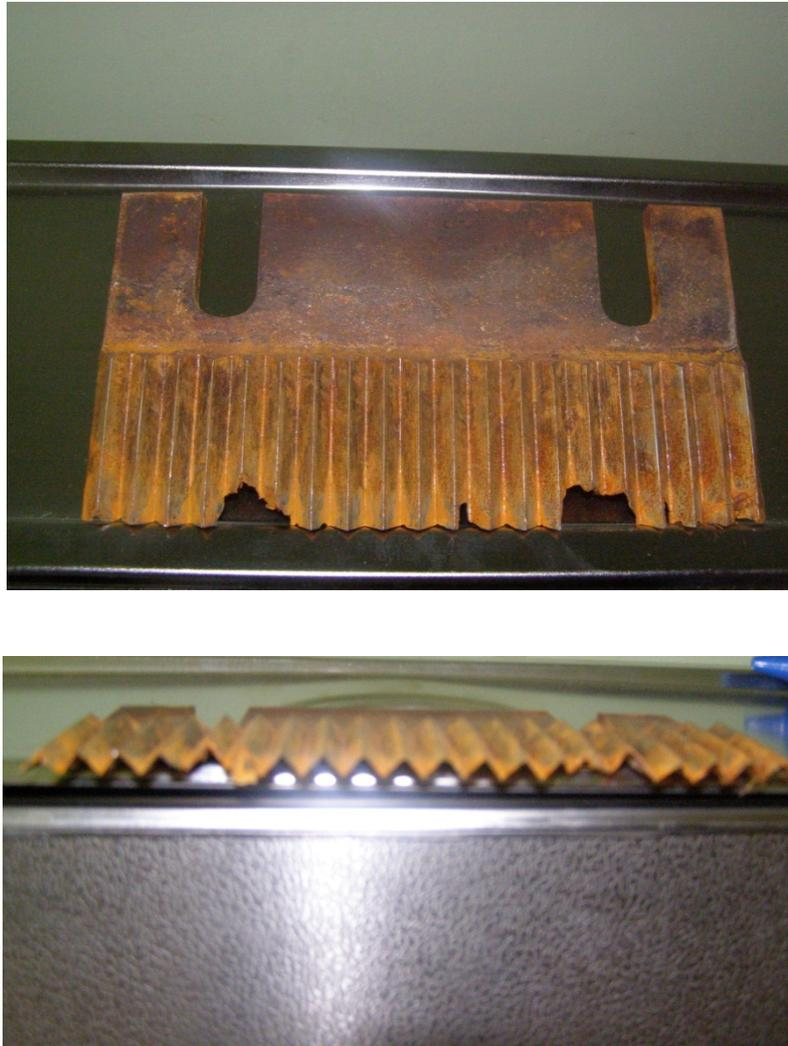
Рисунок 14 – Усталостные разрушения ножей, возникающие при стреле прогиба от 10 до 20 мм
