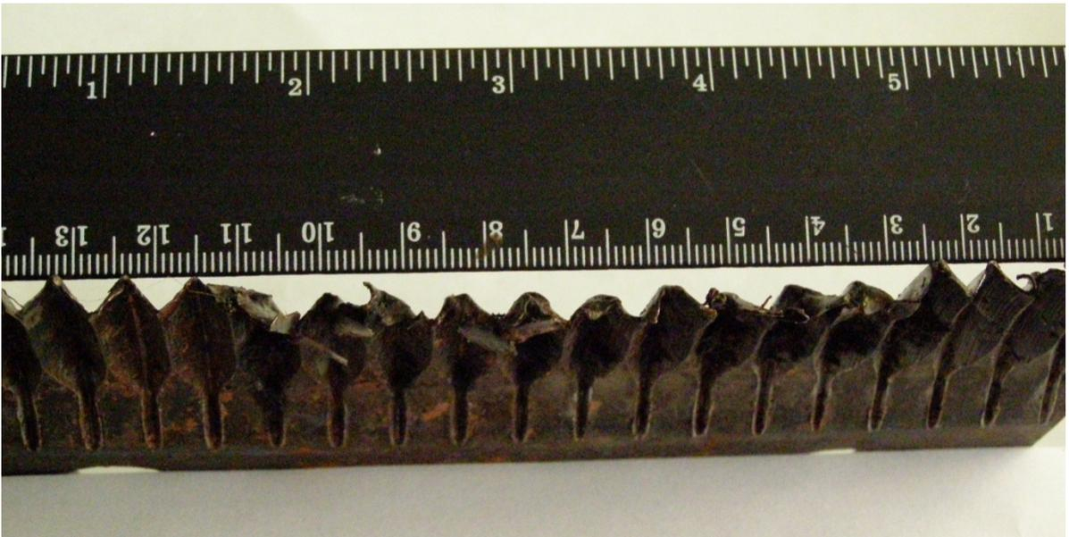
Рисунок 12 – Искривления плоскости граней от ударных воздействий свеклы
