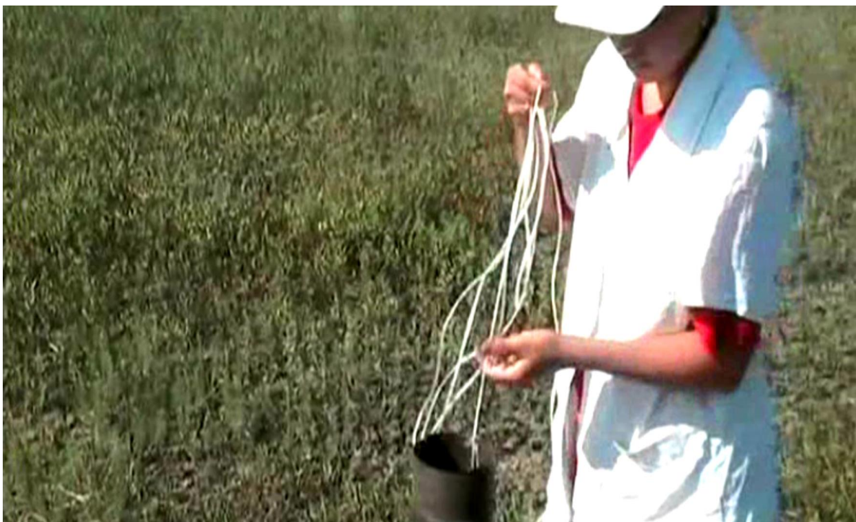
Рисунок 3.2 – Отбор грунтовой воды
