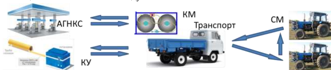
Рисунок 11 – Технологическая схема заправки тракторов природным газом на основе сменных кассетных модулей
