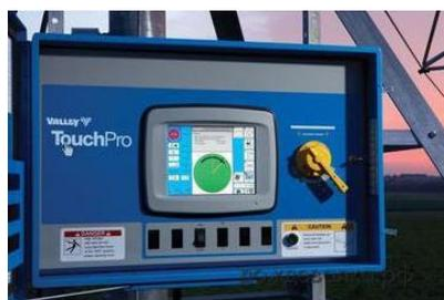
2. **Valley Pro2** получила поддержку GPS и использует передовые технологии, что дает простой набор инструментов для контроля высочайшего уровня и мониторинга как в поле, так и удаленно. Новая функция Cruise Control позволяет выполнять полный или частичный проход оросительной установки за промежуток времени, указанный оператором в приложении, для выполнения регулировок в процессе работ.
