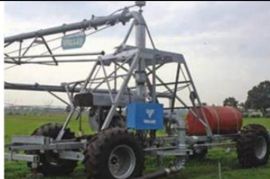
Дождевальная установка **Rainger** с возможностью разворота может настраиваться для покрытия полей с разной шириной и может использовать канал или шланг для забора воды. С добавлением функции разворота пролет сможет поворачиваться на тележке на угол 180°. Функцию разворота можно контролировать с панелей управления Classic Plus, Select2, Pro2, AutoPilot Linear.
