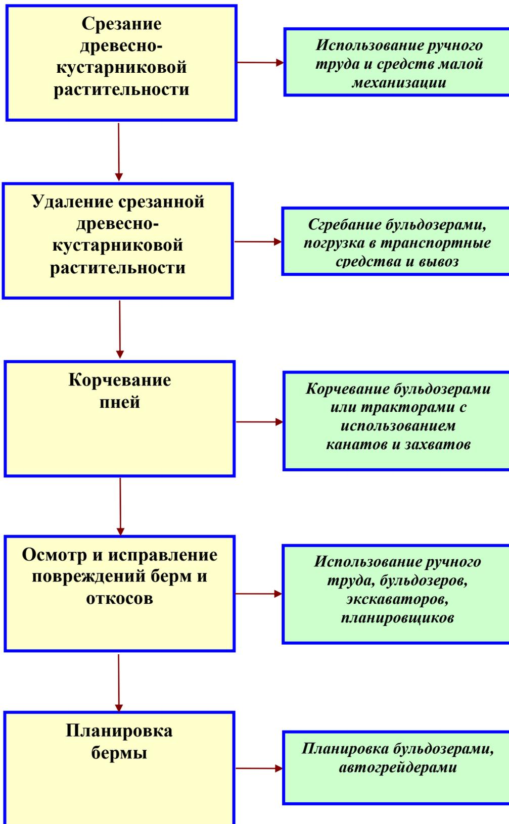
Рис. 1.3. Технология очистки оросительных каналов от кустарника и мелколесья
