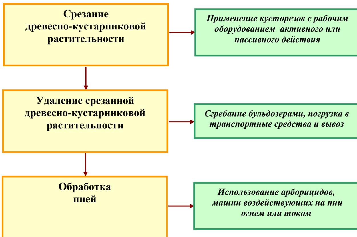
Рис. 1.4. Усовершенствованная технология удаления древесно-кустарниковой растительности на каналах
