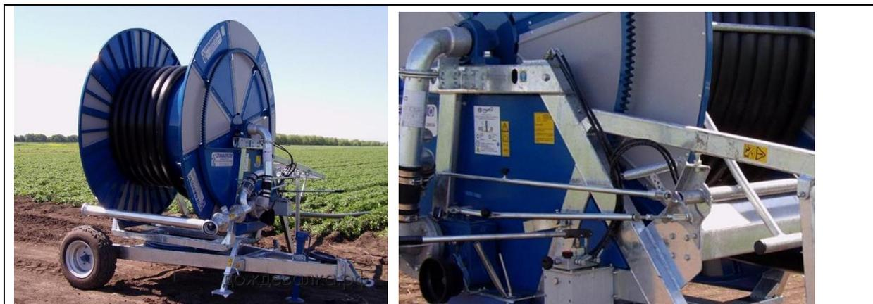
Широкозахватные дождевальные машины испанской компании **RKD** используются для орошения полей среднего и большого объема. Радиус одной машины может достигать 800 метров. В каждом случае тип и модель дождевальной машины проектируется под нужды и характеристики отдельно взятого хозяйства.
