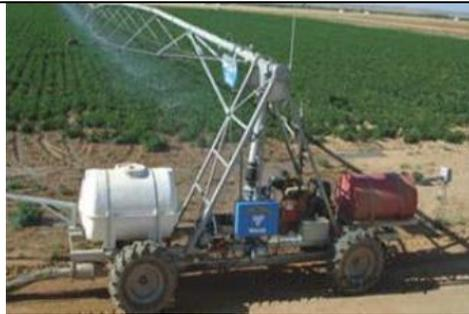
Фронтальная дождевальная установка **Valley Rainger** может перемещаться по всему полю, обрабатывая до 98% его поверхности. Источником воды могут быть открытые каналы и каналы, а также может использоваться вода из закрытых систем или трубопроводов.
