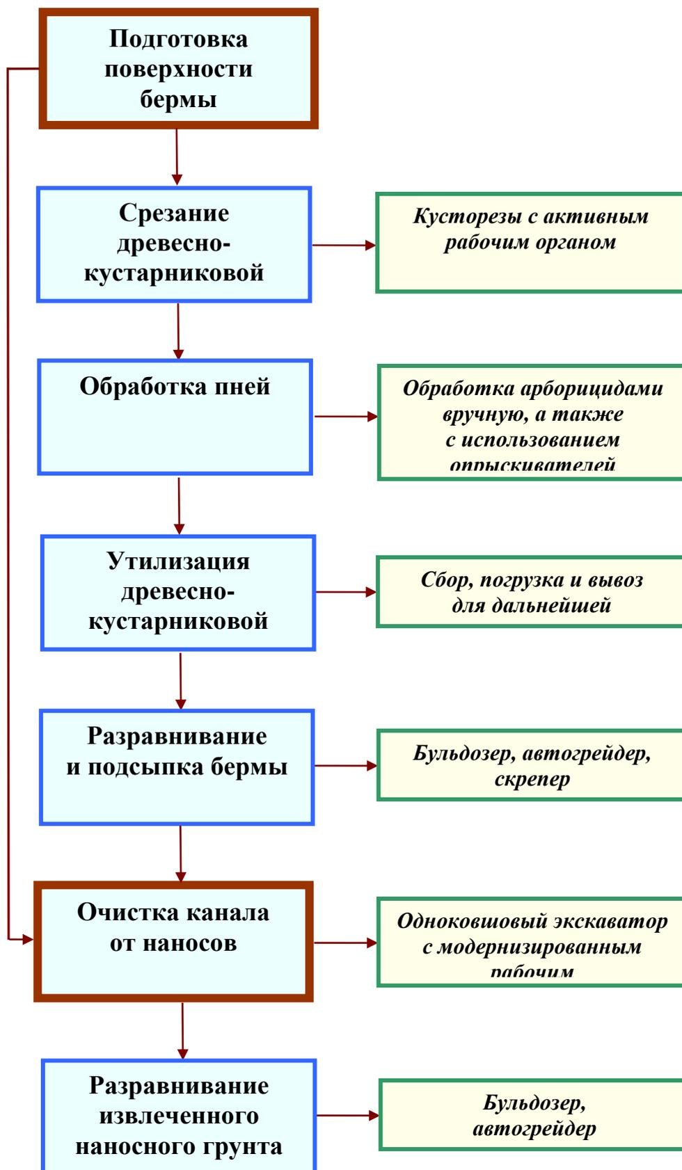
Рис. 1.5. Комплексная технология ремонта и очистки мелиоративных каналов
