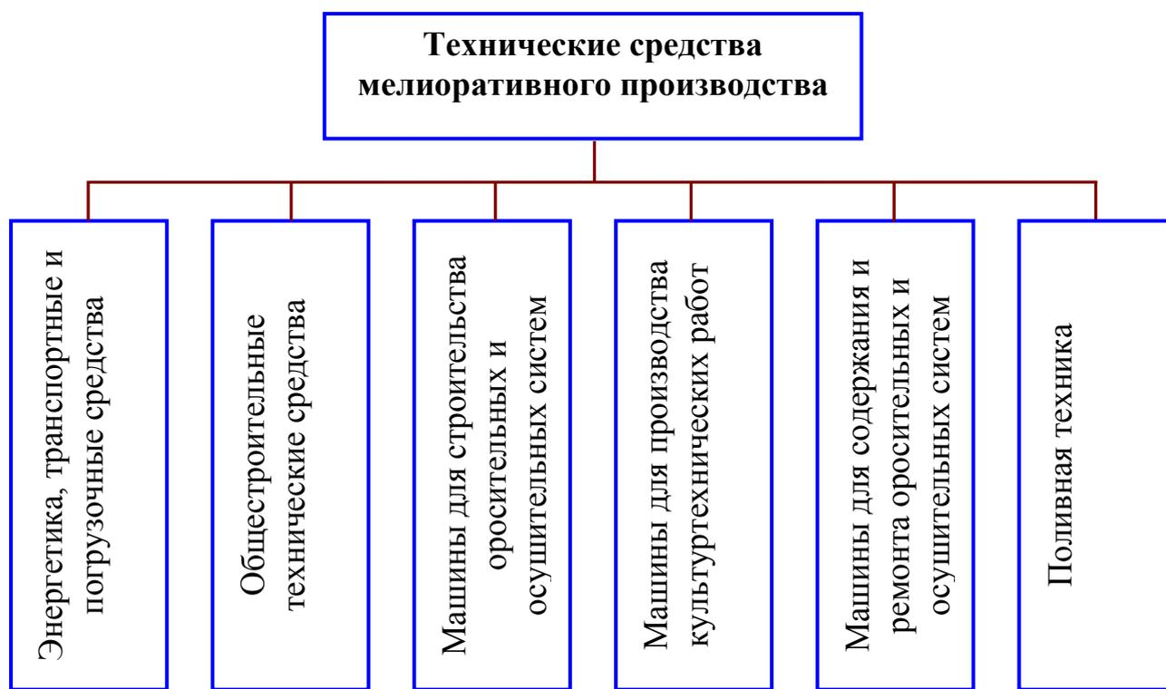
Рис. 2.1. Технические средства, применяемые в мелиоративном производстве
