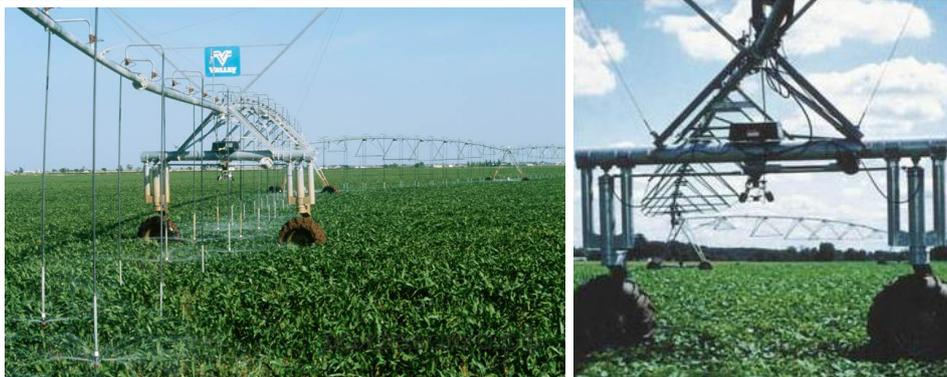
Установка углового орошения **Global Corner от Valley** сочетает в себе лучшие качества установок углового орошения Valley Corner и Valley Precision Corner, и присоединяется к круговой оросительной установке с помощью гусеничного и роликового соединения. Установки углового орошения Global Corner предлагаются с одним из двух пролетов различной длины и легко транспортируются водным транспортом в стандартном контейнере.
