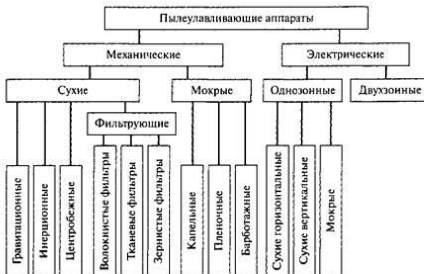
Рисунок – 3. Схема классификации пылеуловителей
