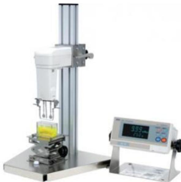
Рис. 3. Внешний вид вискозиметра *SV-100A*
