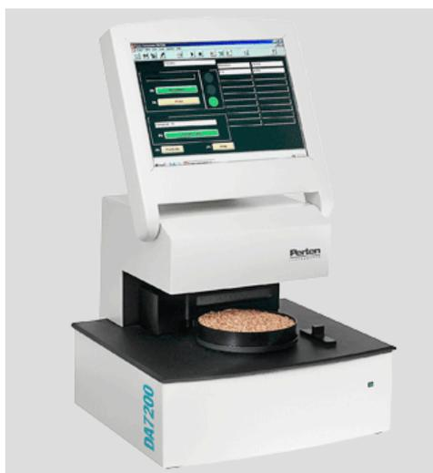
Рис. 8. Инфракрасный анализатор активности воды *DA7200NIR* (*Decagon*)
