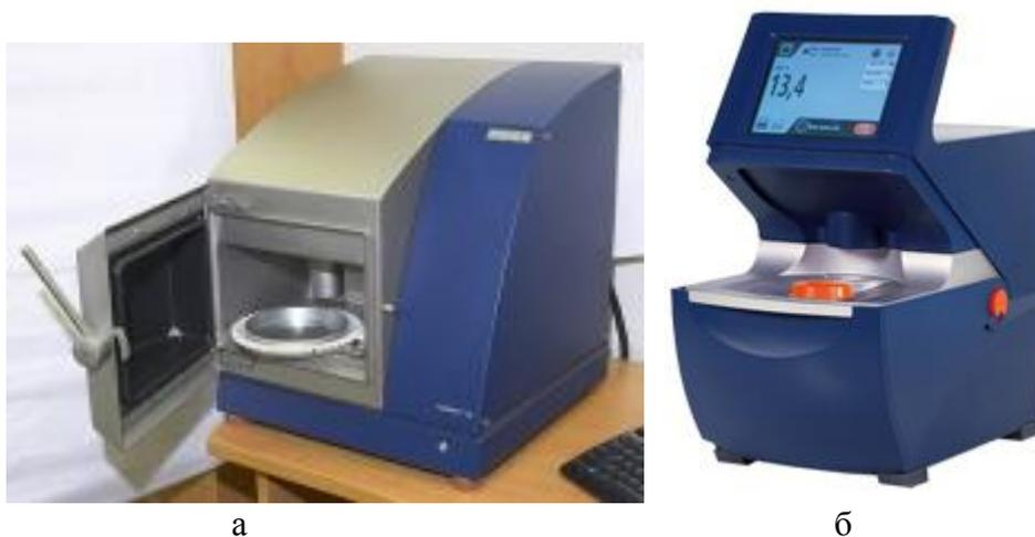
Рис.7. Экспресс анализаторы *FoodScan Lab/Pro* (а) и *MeatScan* (б)
