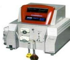
Предел обнаружения РФА  $10^{-2} - 10^{-3}\%$ , однако возможно определение и больших концентраций (десятки %). Точность 2-5%. Применяется для анализа проб не только в жидком, но и твердом состоянии. Легко автоматизируется и поэтому широко используется в заводских лабораториях для поточных анализов.
