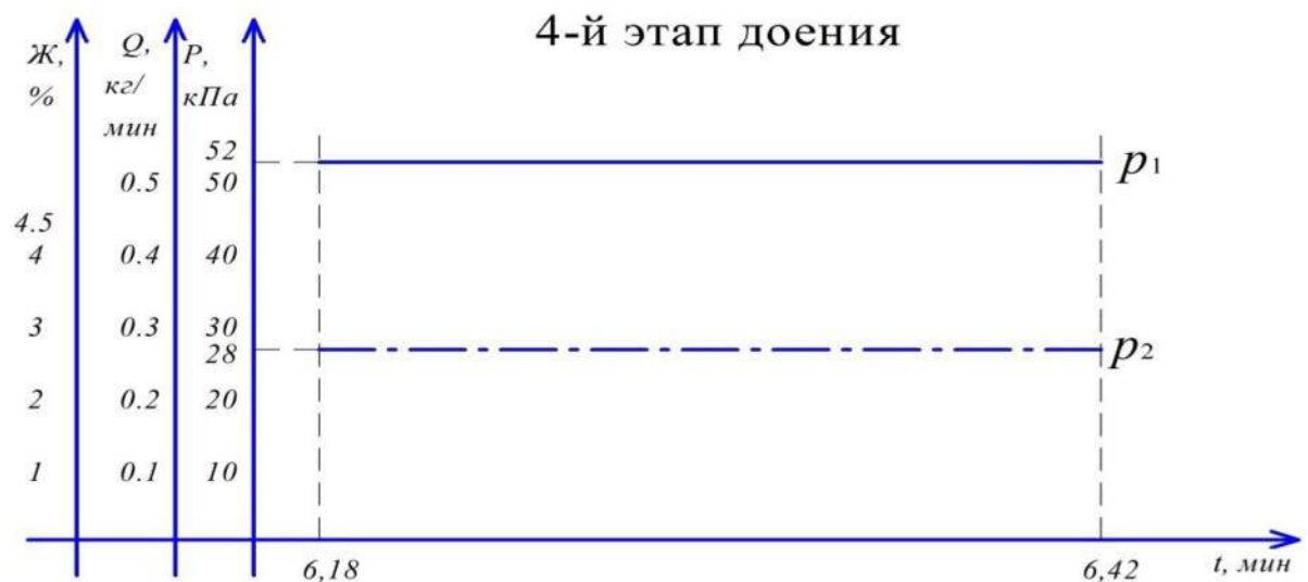
Рисунок 2.11 – График изменения вакуумметрического давления в зависимости от времени доения на заключительном этапе доения:
