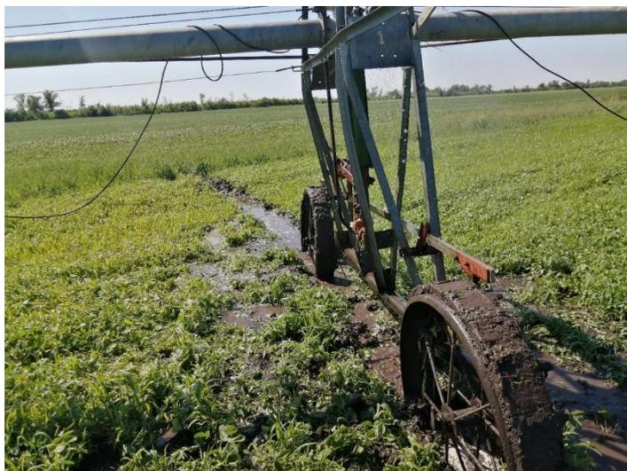
**Рисунок 1. Вид образования колеи от движения по полю дождевальной машины кругового действия**
