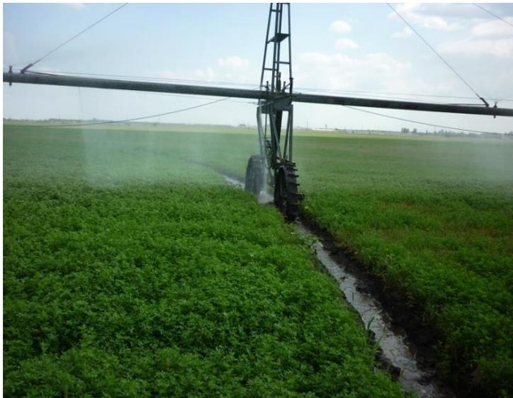
**Рисунок 1. Колееобразование ДМ «Фрегат», приводящее к пробуксовке машины и разрушению почвы**
