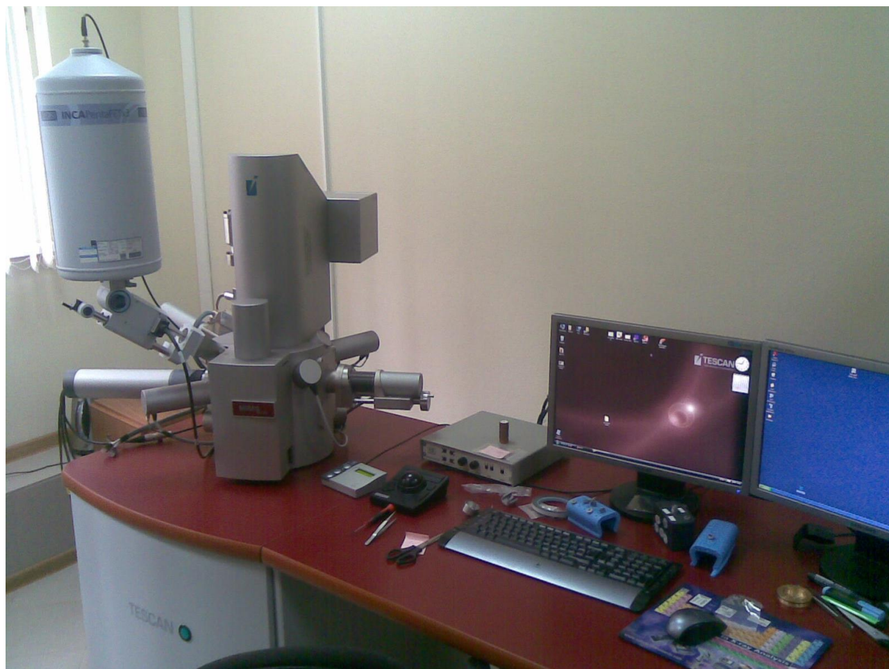
Рисунок 3.11 – Исследовательский комплекс «MIRA II TESCANA»
