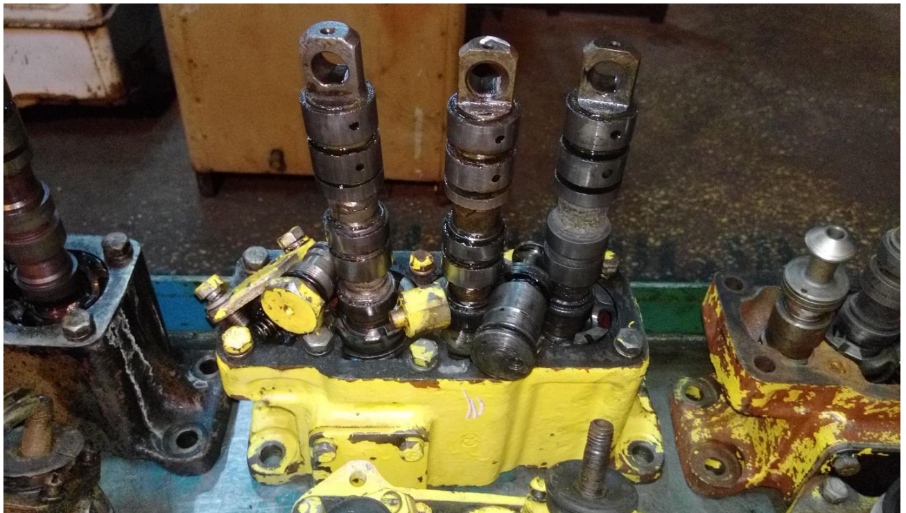
Рисунок 3.18 – Гидрораспределители Р160 3/1-222, восстановленные по предлагаемой технологии с использованием НКЭП на основе железа
