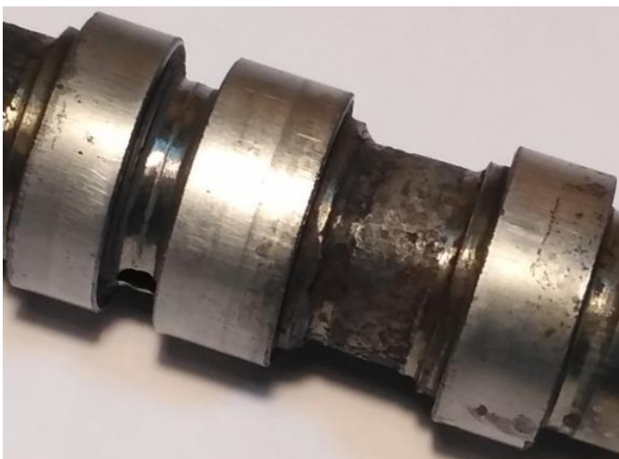
Рисунок 1.6 – Изношенная поверхность рабочих поясков золотника гидрораспределителя Р160
