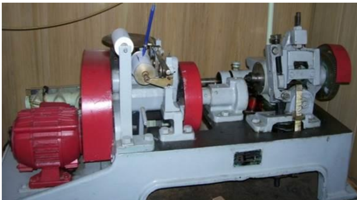
Рисунок 3.13 – Машина трения МИ-1М
