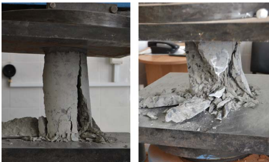
Рисунок 3. Характер разрушения кернов, извлеченных из массива фундаментной плиты: слева — из верхней части плиты (характер разрушения неудовлетворительный), справа — из нижней части плиты (характер разрушения удовлетворительный)
